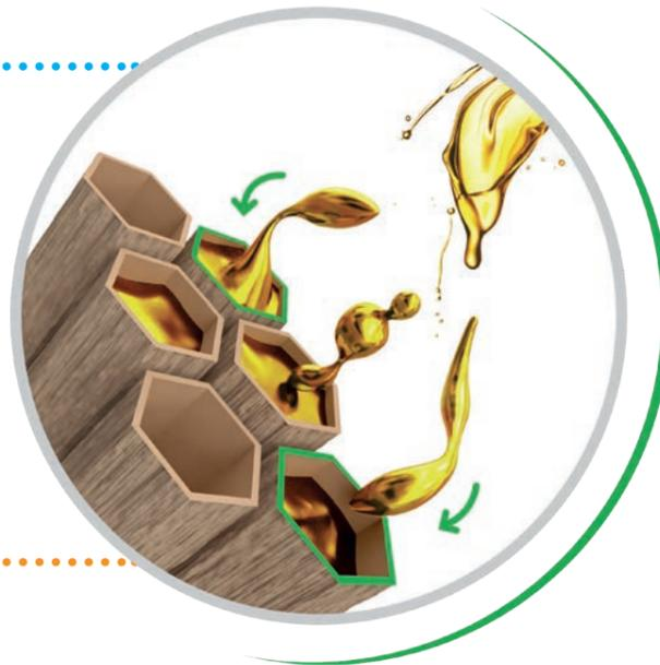
Grazie alla sua struttura microalveolare, il Clean Up Powder incapsula i liquidi per separarli dall'assorbente riutilizzabile mediante un sistema di setacciatura.
