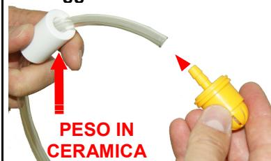
Tagliare il tubo alla lunghezza necessaria. Collegare la valvola di fondo gialla / filtro al tubo, come indicato sopra. Scorrere il peso in ceramica lungo il tubo e sovrapporlo il più possibile sopra il raccordo dentellato della valvola di fondo gialla.
