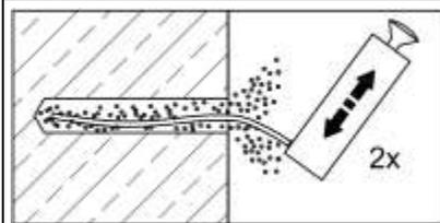
Zum Abschluss nochmals mit 2 Hüben vom Bohrlochgrund her ausblasen, bis die rückströmende Luft keinen erkennbaren Staub mehr enthält.
