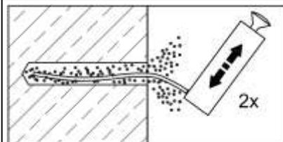
Bohrlöcher mit einem Durchmesser  $\leq \varnothing 22$  mm und einer Verankerungstiefe bis  $h_{ef} \leq 10d$  können mit der Handpumpe ausgeblasen werden..
