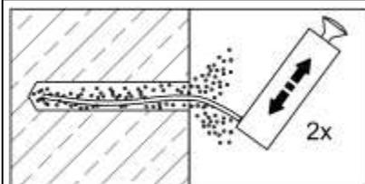
Nochmals mit 2 Hüben vom Bohrlochgrund her ausblasen, bis die rückströmende Luft keinen erkennbaren Staub mehr enthält.
