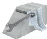
5. Nach Beendigung der Aushärtezeit (Farbwechsel oder nach Aushärtezeitabelle) darf das Anbauteil montiert und die Mutter mit kontrolliertem Drehmoment angezogen werden.
