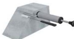
2. Reinigung des Bohrlochs durch mindestens 4x ausblasen / 4x bürsten / 4x ausblasen. Danach Den den Injektionsmörtel solange auspressen bis der Mörtel richtig gemischt und eine gleichmäßige Farbe aufweist. Nicht gleichmäßig gemischter Mörtel härtet nicht aus und ist zu verwerfen.
