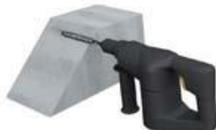
1. Bohrloch, unter Verwendung des passenden Bohrerdurchmessers, in der erforderlichen Bohrtiefe schlag- bzw. hammerbohend erstellen.
