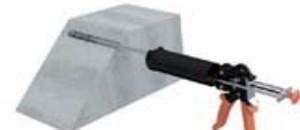
3. Der Injektionsmörtel ist vom Bohrlochgrund beginnend, langsam hubweise, zu injizieren bis das Bohrloch zu etwa 2/3 gefüllt ist.
