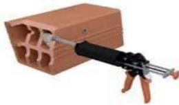
4. Den Injektionsmörtel solange auspressen bis der Mörtel richtig gemischt und eine gleichmäßige Farbe aufweist. Nicht gleichmäßig gemischter Mörtel härtet nicht aus und ist zu verwerfen. Der Injektionsmörtel ist vom Bohrlochgrund beginnend, langsam hubweise, zu injizieren bis das Bohrloch vollständig gefüllt ist.
